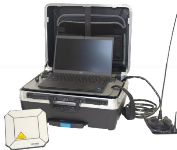
El centro de control móvil es un maletín que en su interior dispone de todo lo necesario para poder monitorizar y llevar a cabo la ejecución de un plan de emergencia.
